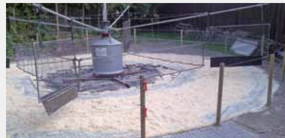
Führanlage mit stoßabsorbierendem TTE®-Pflasterboden
