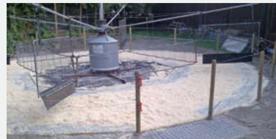
Führanlage mit stoßabsorbierendem TTE®-Pflasterboden
