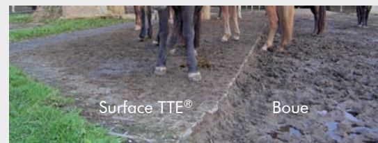
Surface en cas de mauvais temps : les consolidations partielles peuvent être agrandies en tout temps.
